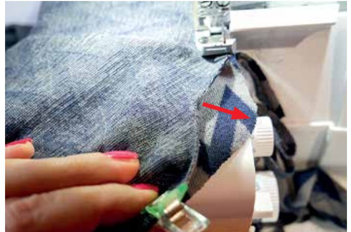
Bis zu den engen Kurven nähen. Dann die stumpfe Ecke (oben) an die „spitze“ Ecke (unten) übereinander legen...
