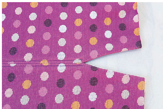
... und auf beiden Seiten der Rückennaht bis zum Schlitzbeginn schmal absteppen.
