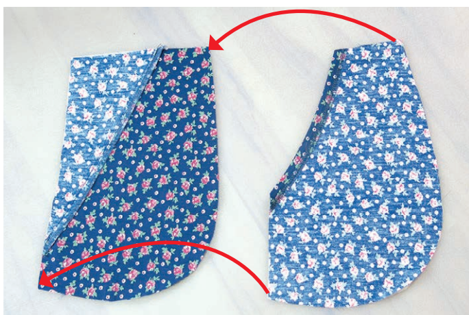
Auf den hinteren Taschenbeutel (linke Seite nach oben) den vorderen Taschenbeutel (linke Seite oben) legen, feststecken und füßchenbreit zusammen nähen.
